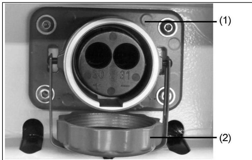
Abb. 5-6: Fremdstartereinrichtung anschließen
