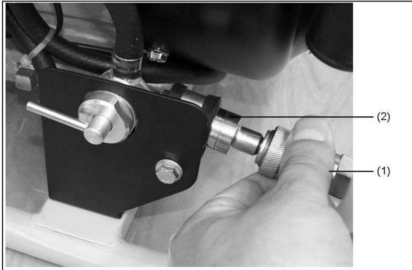
*Abb. 5-12: Betankungsgerät anschließen*
