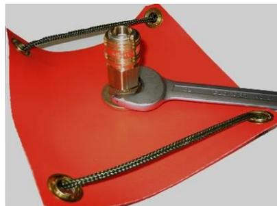
Kontrollieren Sie, ob das Überdruckventil festgezogen ist. Ziehen Sie die Bauteile ggf. von Hand nach. **Nicht überdrehen!**
